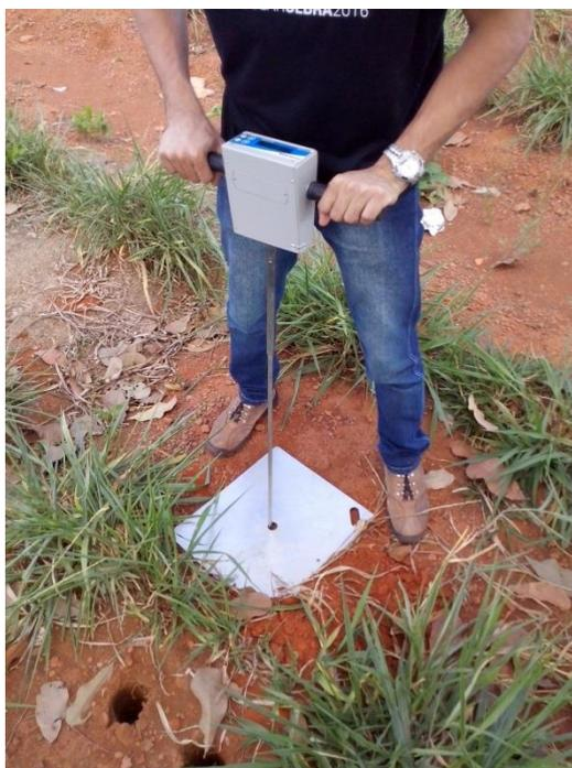
**Figura 4.** Mensuração da resistência do solo com o equipamento – Falker – PLG 1020.
